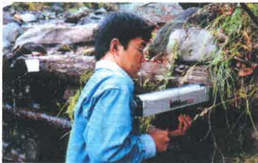
穿孔抵抗試験器(レジストグラフ)による計測
