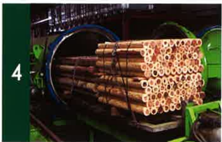
4 タンクに「圧縮加工処理材」を搬入
